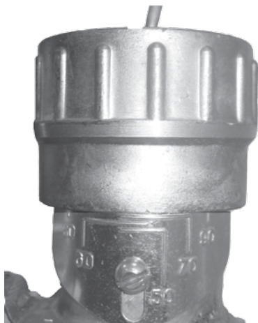
Рисунок 3. Положение гайки регулировочной при T теплоносителя 70°C.
