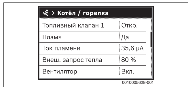
Рис. 32 Ток ионизации (пламени) в меню мониторинга
