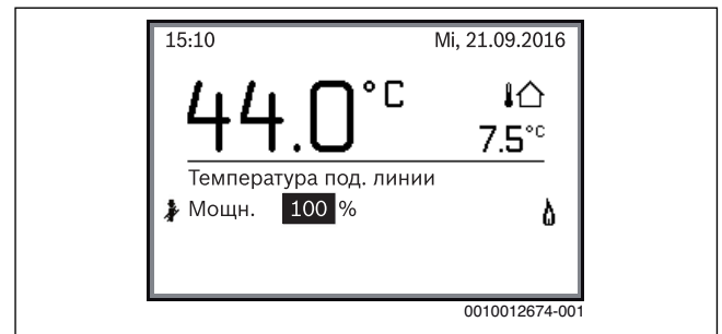
Рис. 29 Активен режим "трубочист"
